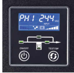
UPS durumu ve ölçümleri için LCD
